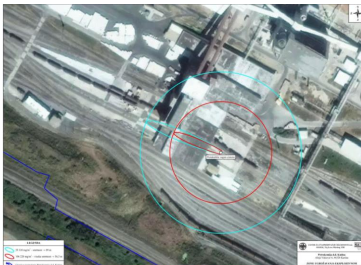
Slika 8. Zone ugrožavanja eksplozivnom koncentracijom plinovitog amonijaka – scenarij VII.1. izvor: Izvješće o sigurnosti; Petrokemija d.d. tvornica gnojiva, travanj, 2019.
